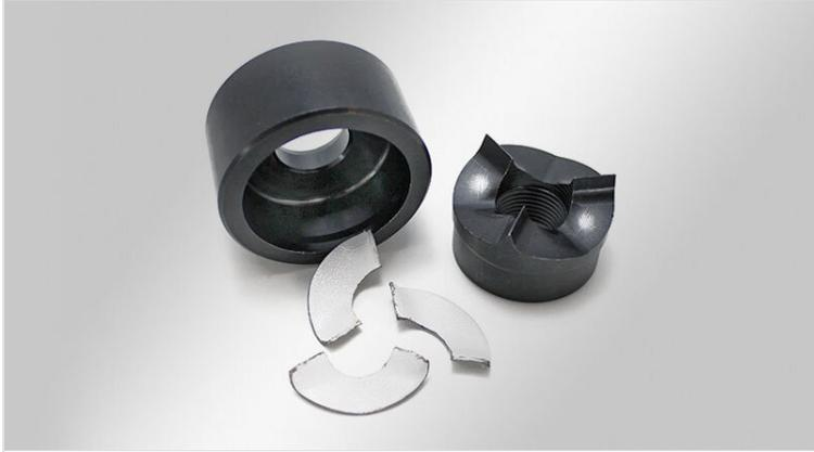
Dieser Blechlocher für Edelstahl, Stahlblech, Aluminium und Kunststoff spaltet das Abfallstück je nach Typ in mehrere Teile. Auf diese Weise wird das Festklemmen der Abfallstücke an der Hydraulikschraube und in der Matrize verhindert. Für Hand- und Hydraulikbetrieb.
